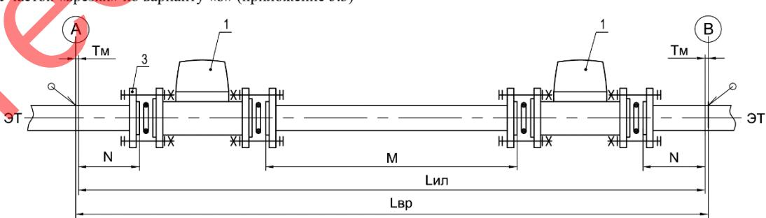
Рисунок Г.2 – Составные части участка «врезки» ИРВИС-Ультра-Пп-16-DN150...DN400
