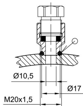
Рисунок Г.3 – «Врезка» штуцеров в ЭТ при монтаже ПП ИРВИС-Ультра-Пп
