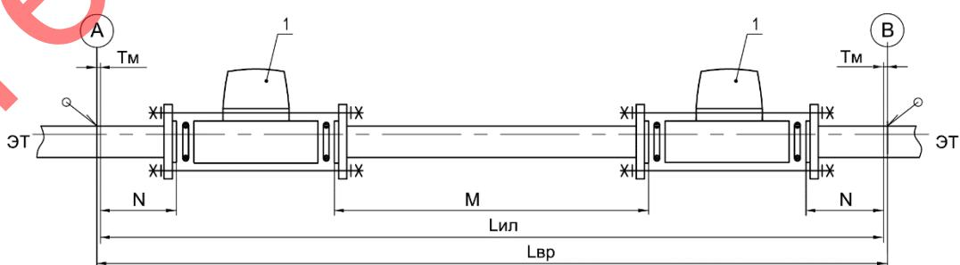
Рисунок Г.1 – Составные части участка «врезки» ИРВИС-Ультра-Пп-16-DN50
