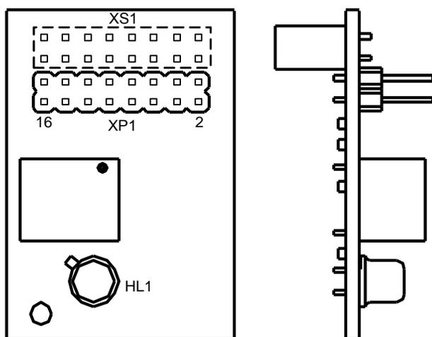
*XP1 – колодка подключения шлейфа связи с модулем индикации;
